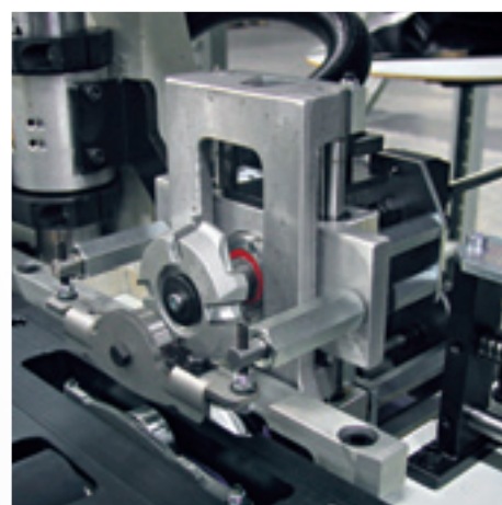
Fresas 75 mm con perfil radio 2 mm
