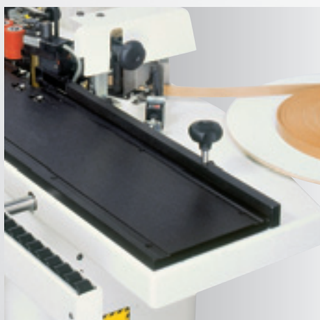
Guía en entrada registrable con indicador numérico (mm/pulgadas)
