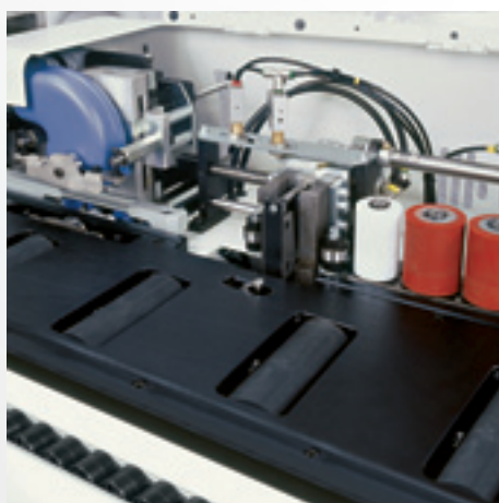
Rodillos sobre la mesa de soporte y dirección del panel
